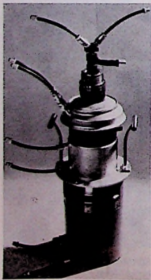
Gezien op de Salon Electrique in Parijs. De grootste Thyatron ter wereld, type E 2986 van GEC. Het nieuwe van deze thyatron is zijn metalen mantel, waarmee het rooster een geheel vormt. 35 kV, 1000 A top, gew. stroom 15 A.
